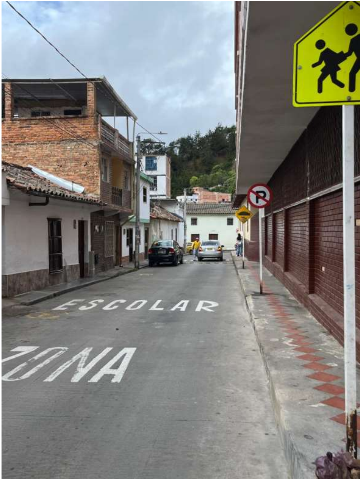
Señalización horizontal de zona escolar. Señalización vertical de prohibido estacionar y reductor de velocidad.
